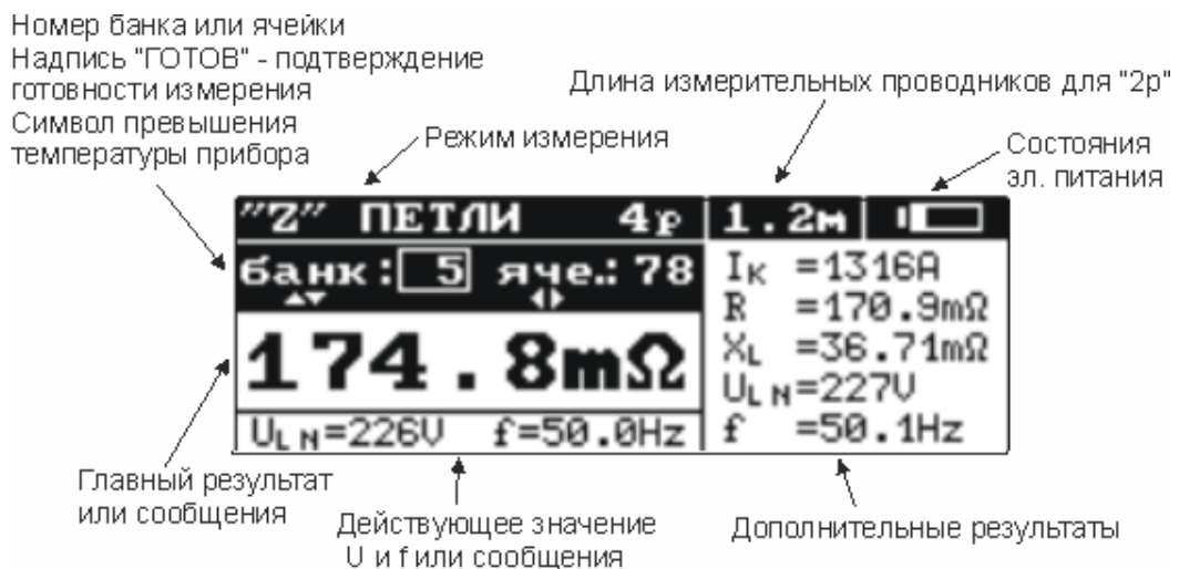
Вид экрана в режиме измерения полного сопротивления петли короткого замыкания (все результаты)
